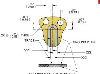
**GROUNDED COPLANAR BOARD** TERMINATION CONFIGURATION
